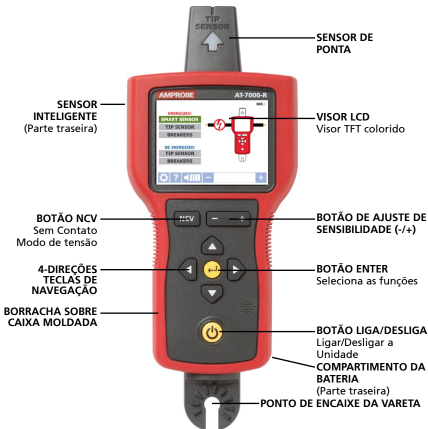
Figura 1: Visão geral do receptor AT-7000-R
