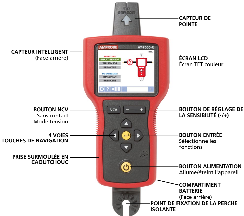
Figure 1 : Vue d'ensemble du récepteur AT-7000-R
