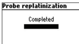
Extraiga la sonda de la solución de replatinización y enjuáguela con agua desionizada.
