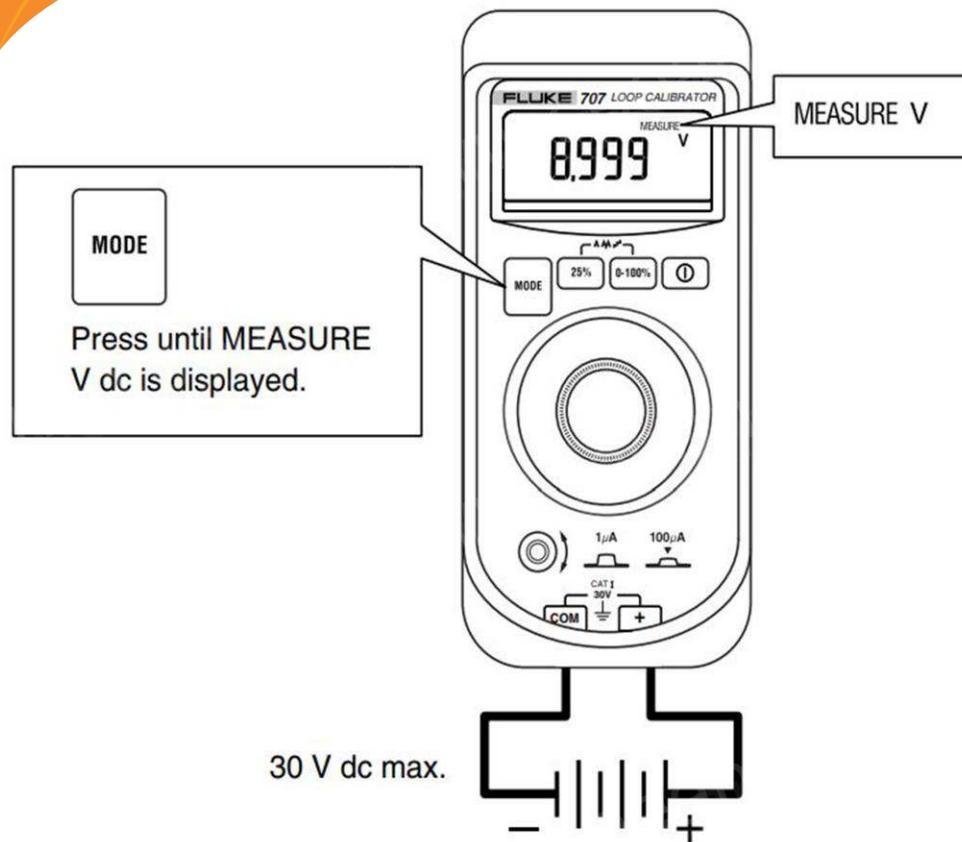
اندازه گیری ولتاژ
