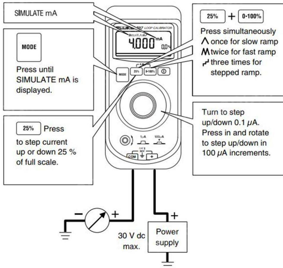
مد شبیه سازی Transmitter را در این مد دستگاه به عنوان یک شبیه ساز و ترانسمیتر عمل می کند در این حالت دستگاه جریان حلقه را در رنج انتخابی شما محدود می کند برای این کار رابط ها را مطابق با شکل به مدار متصل کنید
