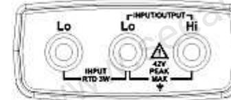
اندازه گیری میزان مقاومت دمایی RTD Pt100 و ۴۰۰ اهم
